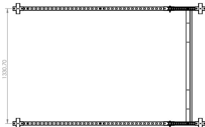
1. Fabricado con lámina de acero calibre 11, 16 y estructura de unistrut
