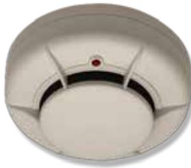
Detector de humos óptico convencional de perfil extraplano con led de señalización. Supervisión de funcionamiento mediante parpadeo del led. Diseño de cámara que reduce los efectos de la suciedad y accesible sin necesidad de herramientas especiales para mantenimiento. Microsensor incorporado, activable mediante haz de rayo láser codificado para prueba remota. Salida para piloto indicador de acción.
