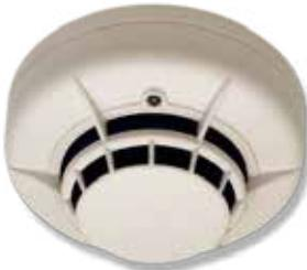
Detector óptico de humos y térmico-termovelocímetro (58 °C ... 8 °C/minuto) convencional con led de señalización. Supervisión de funcionamiento mediante parpadeo del led. Diseño de cámara que reduce los efectos de la suciedad y accesible sin necesidad de herramientas especiales para mantenimiento. Microsensor incorporado, activable mediante haz de rayo láser codificado para prueba remota. Salida para piloto indicador de acción.
