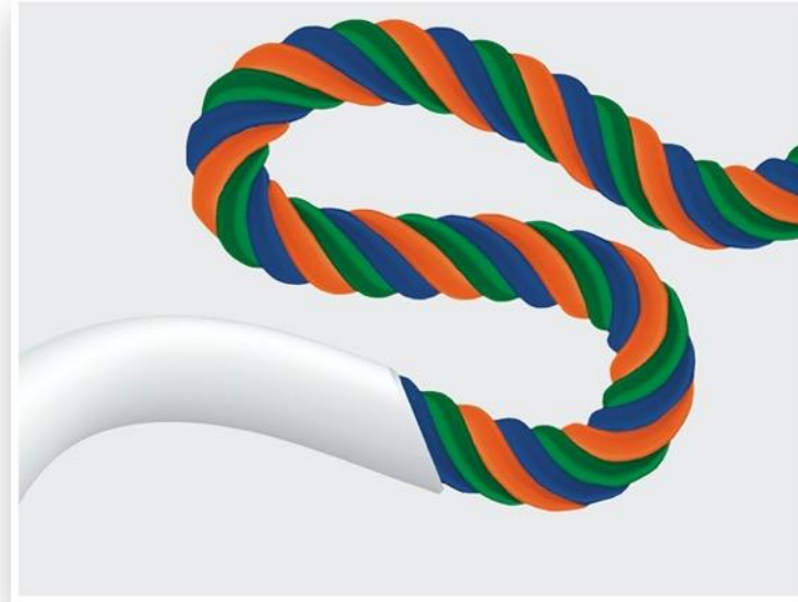
Cada conductor se estira de igual forma alrededor de los dobleces.
