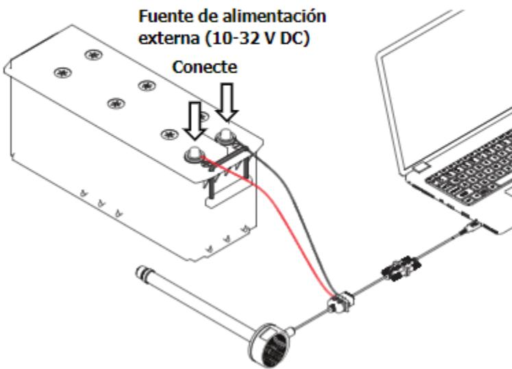
Una vez conectado se realiza la actualización de firmware y calibración como se muestra en la guía de usuario
