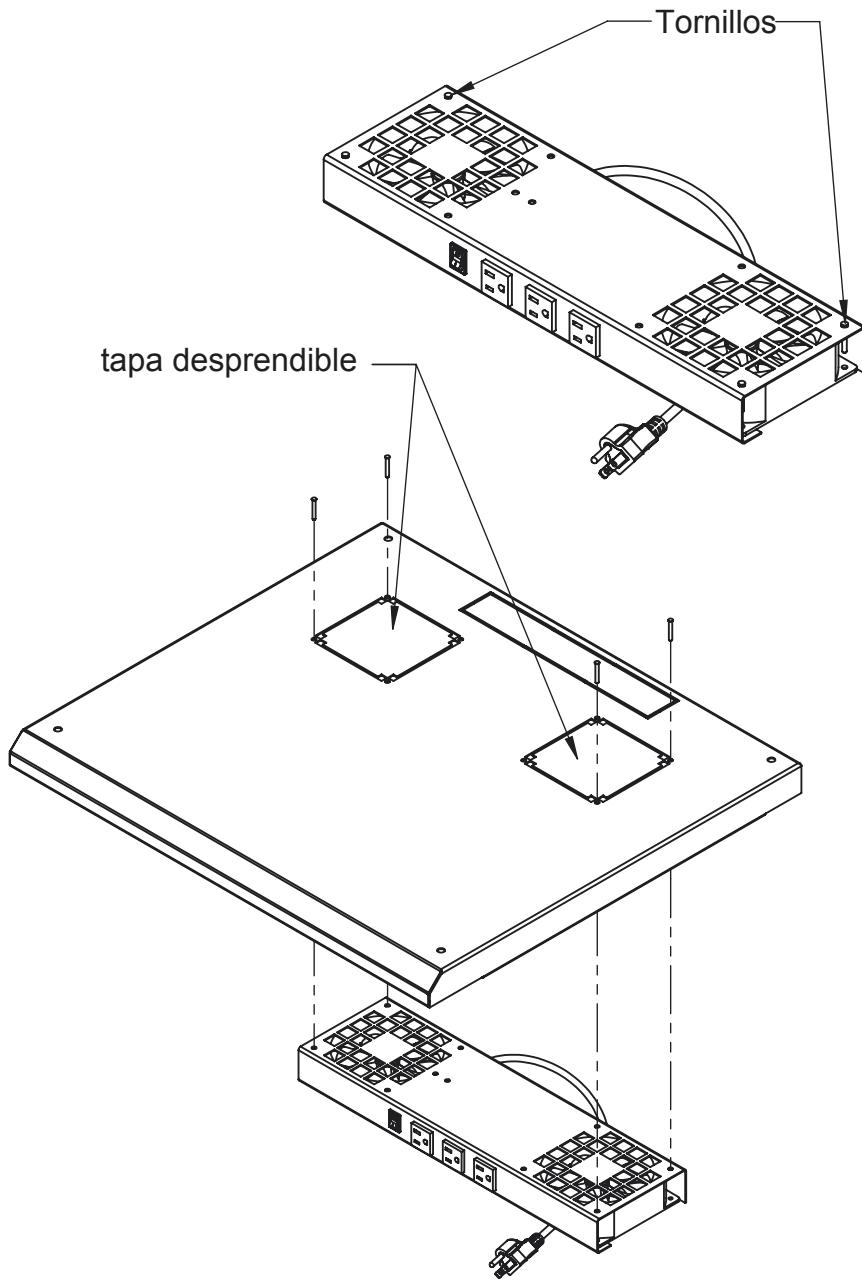
1. Desmonte los 4 tornillos largos en las esquinas del montaje. No pierda de vista el cable de aterrizaje a tierra.
