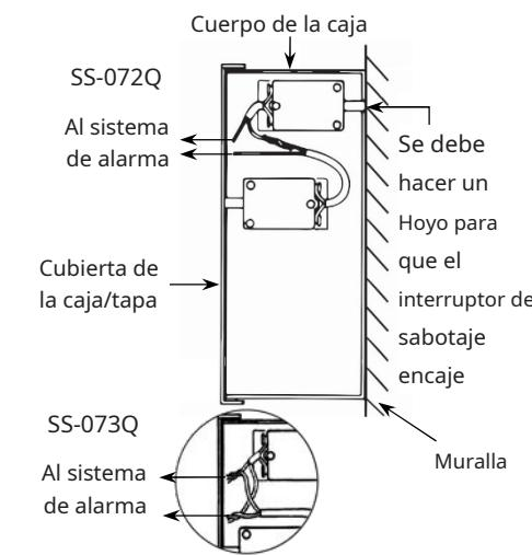
**Figura 3**-Se usa dentro de la caja cuando la parte superior está abierta hacia arriba o se levanta
