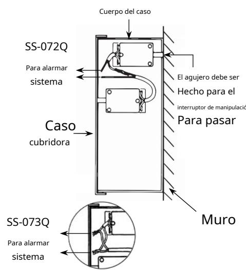
**Figura 3**-Se utiliza dentro de la caja cuando la parte superior está abierta hacia arriba o levantado
